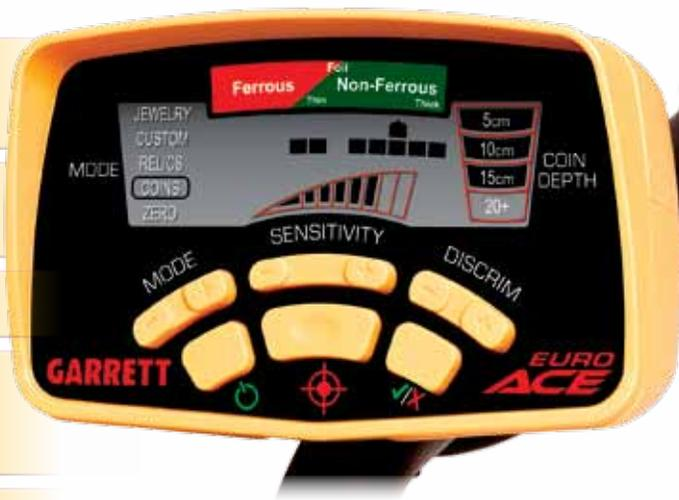
Das Display zeigt ein non-ferrous (nicht-eisen) Objekt bei 15 cm Tiefe. Die PinPoint-Taste des EuroACE zeigt exakt genau die Position des georteten Objekts. Nägel und andere Schrottmetalle werden in diesem Suchprogramm "COINS" nicht angezeigt.
